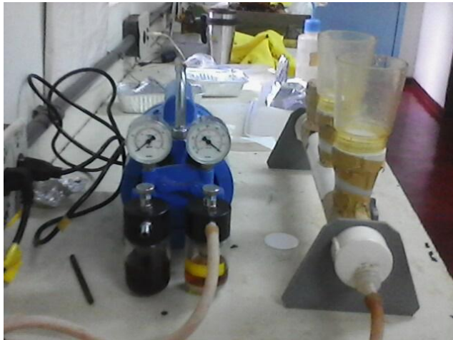
Figura 11- Equipamento utilizado na obtenção da carga suspensa total e volátil das amostras de água do rio Ivaí
